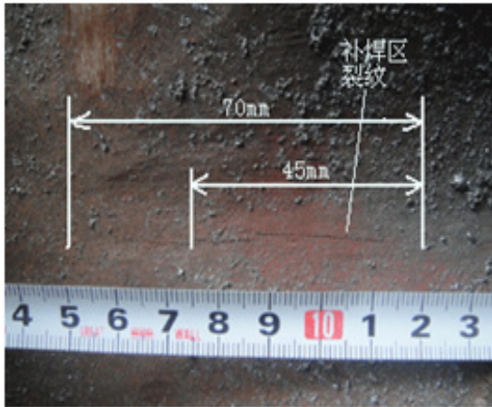
图 2 三通内表面裂纹示意图
